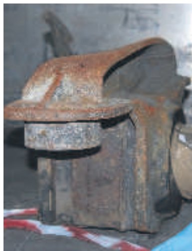
La «boccola» deformata
